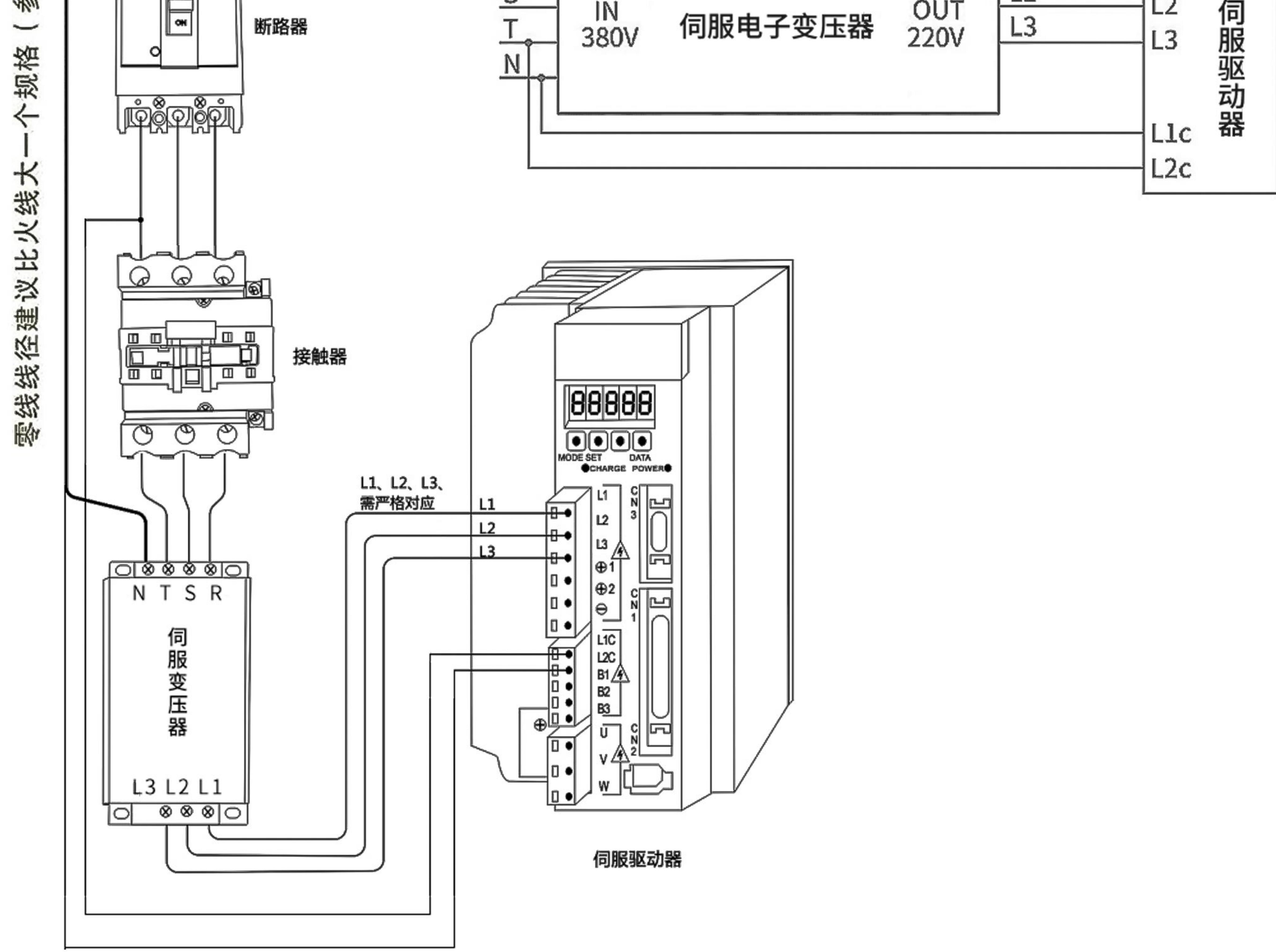
RST为输入端相线 N为输入端零线 L1L2L3输出端接口(必须接牢固)
